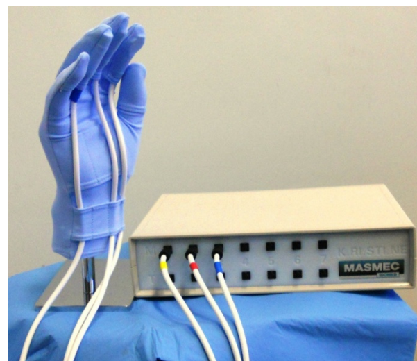
Primo prototipo di stimolatore per la mano con attuatori meccanici e termici
