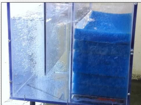
Simulazione per valutare la capacità di smaltimento in presenza del mezzo filtrante
