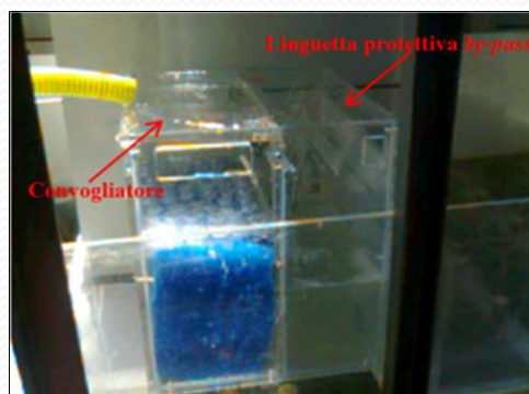
Verifica funzionamento del convogliatore e della linguetta protettiva by-pass
