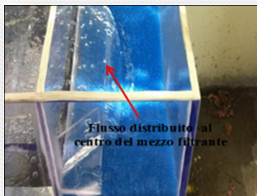
Modifica degli elementi per il convogliamento delle acque verso l'unità di trattamento
