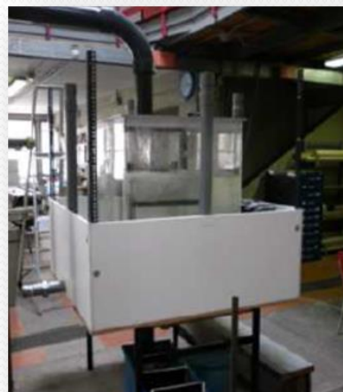
Prove di tenuta e capacità di smaltimento acque
