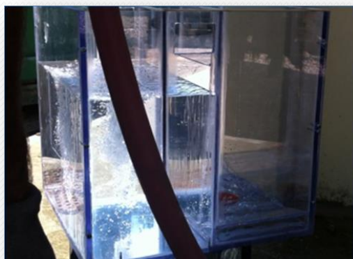
Simulazione per valutare la capacità di smaltimento in presenza del mezzo filtrante
